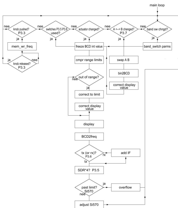
fig 7 Aparte VFO voor zenden en/of ontvangen (A<->B)
