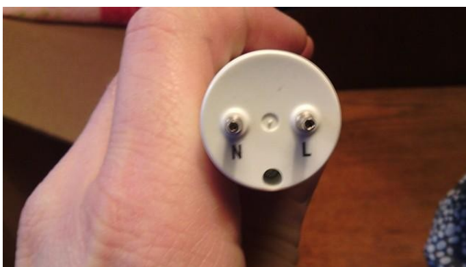
Foto 5 : aansluiting van Philips LedTube
