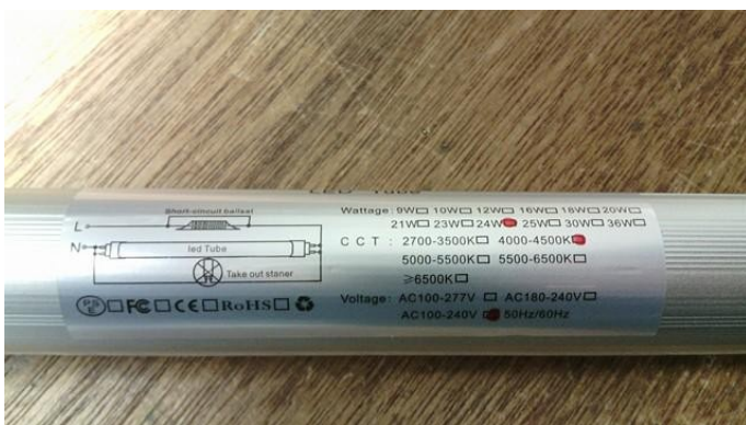
Foto 3 en 4 : aansluiting van merkloze LedTube
