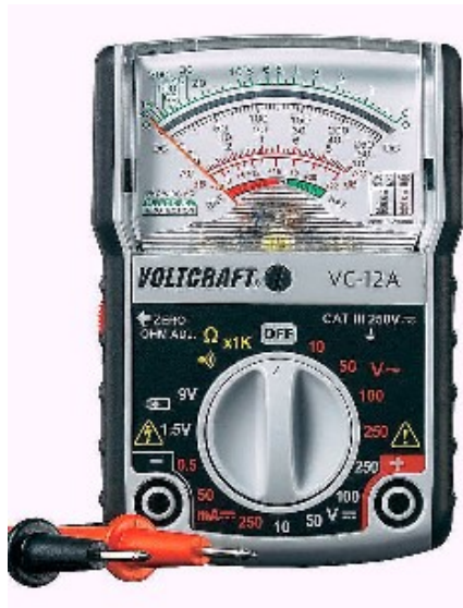
Figuur 1 Een ‘ouderwetse’ draaispoelmeter. Conrad-prijs: € 17,99 (incl. BTW, excl. Verzendkosten, prijspeil mei 2016). Door zijn mechanische traagheid wijst hij primair de gemiddelde waarde aan. Een gelijkrichtschakeling is reeds ingebouwd. Bij de kalibratie voor wisselspanning wordt zo’n meter 11% gevoeliger gemaakt. Daardoor wijst hij voor sinusvormige signalen toch effectief aan.
