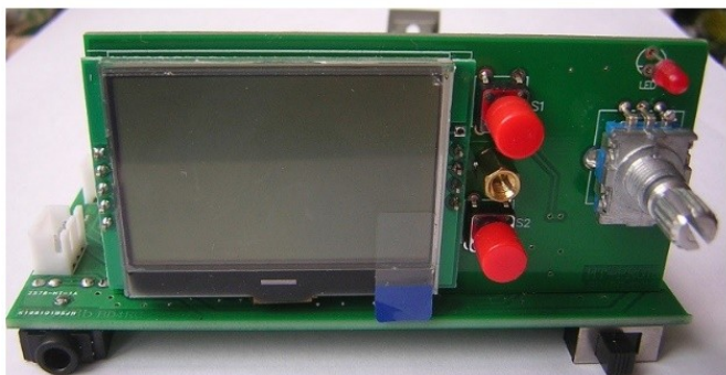
Displayboard gemonteerd op main board.
