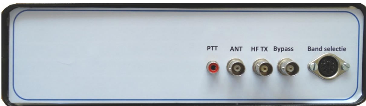
Fig. 50, Achterzijde LowPass Filter en PA-behuizing.
