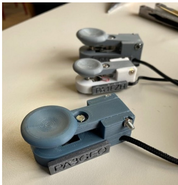
CW-sleutels uit de 3D printer.
