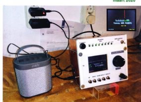
In dit nummer: De Teensy SDR ontvanger gebouwd door PA3EPQ. Update: Verzwakker, 5 bandfilters en 20dB versterker.
