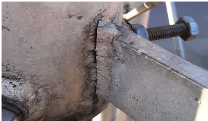
Een aantal lassen waren gescheurd en moesten hersteld worden.
