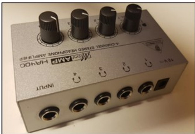
Figuur 1 Voorbeeld van een actieve audio splitter. (Die gaan we dus niet gebruiken)
