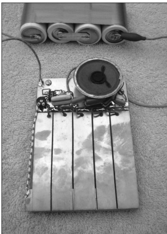
Dit orgeltje klonk nogal vals maar dat is te verhelpen door met geduld de juiste waarden voor de condensatoren uit te zoeken.
