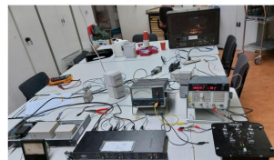
Het testen van de installatie. Links de voeding, zender en toongenerator; midden de omschakelaar en rechts het mengpaneel. Op de achtergrond de achterkant van de buitenradio om de ontvangst te controleren.
