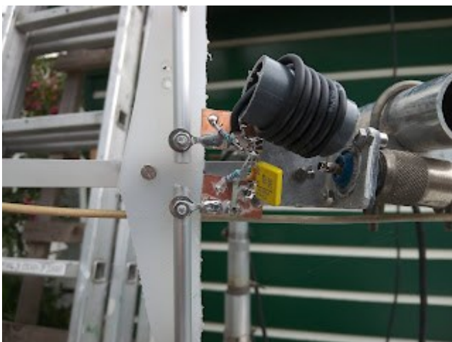
Dipool met dubbele varicap en mantelstroomfilter.
