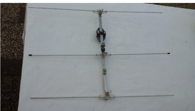
Complete yagi, slechts een 60 cm lange drager.
