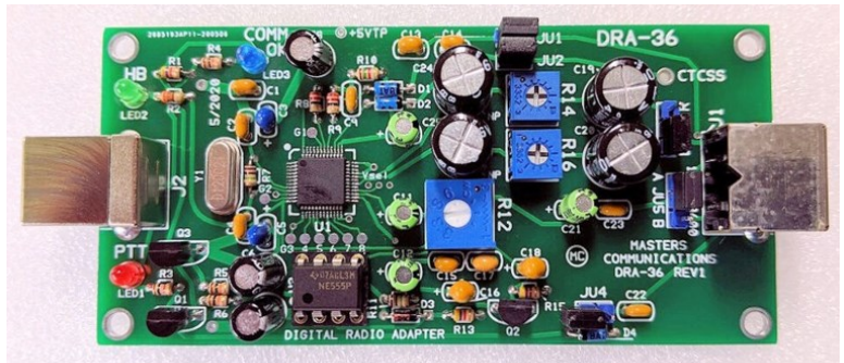
Foto 10 de DRA36, een veel gebruikt soundmodem
