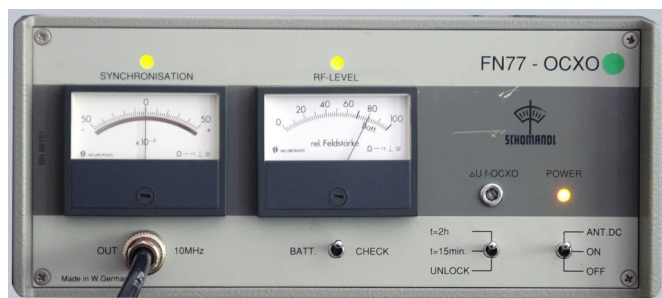
Schema: Schomandl FN77 OXCXO Frequentz Normal
