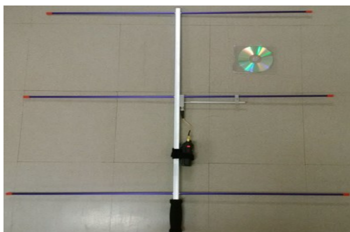
De arrow antenne, hier zijn duidelijk de paarse pijlen te zien die de elementen vormen
