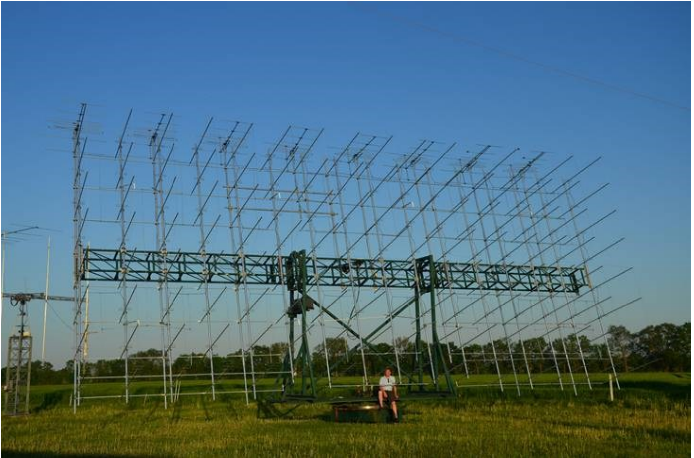
Zelfgebouwde 432 MHz antenne van DL7APV
