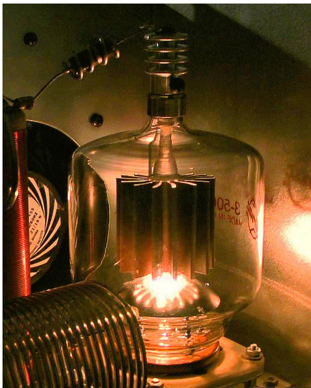
Foto 1 (afbeelding van de Eimac 3-500Z). Wat mooi, zo'n buis. Eigenlijk een soort Nachtwacht! Hij is 'echt' radio-actief, want er zit een beetje thorium in de gloeidraad. Goed voor 1kW, als je hem hard aftapt. Best leuk voor zo'n buis met maar 3 elektroden. (Gepikt van: https://i.ytimg.com/vi/hgZSDyJg8ok/maxresdefault.jpg ).
