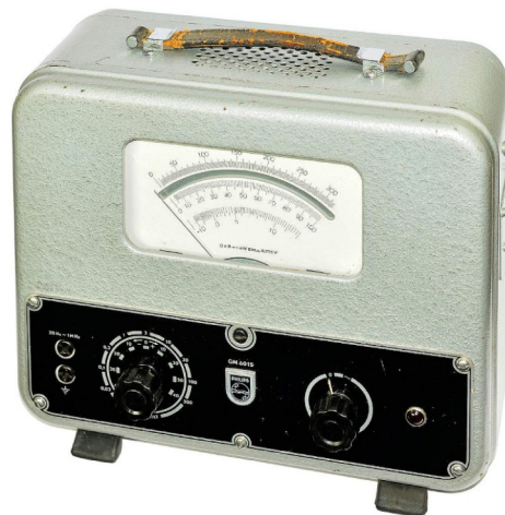
Een buisvoltmeter van Philips GM6015. ( http://www.historische-messtechnik.de/aktive-messgeraete/nf-voltmeter/gm-6015.php )
