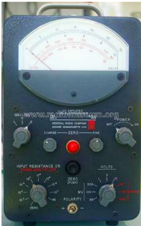
Nog met buizen, de General Radio 1230A. Pico-ampères mat 'ie op zijn slofjes!
