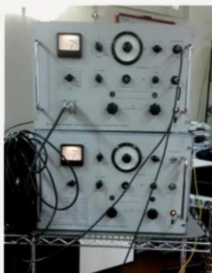
Twee, na reparatie, werkende meetapparaten uit 1959. Het zijn impulsreflectometers type ZUPI van Rohde & Schwarz
