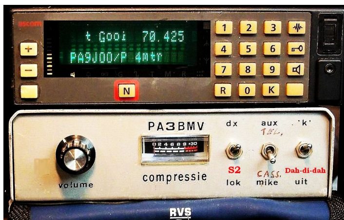
De 'BMV'-limiter met extra frutsels; hier in gebruik met een SE550 voor 70 MHz. S2 dient nu voor 6 dB clipping.
